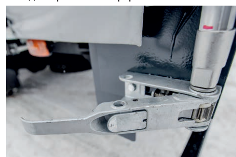
Механизм натяжение боковых сдвижных шторок.
