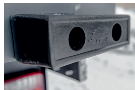
Отбойник резиновый в задней части надстройки
