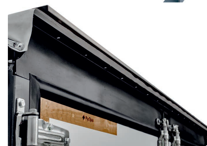
Защитный козырек над распашными воротами
